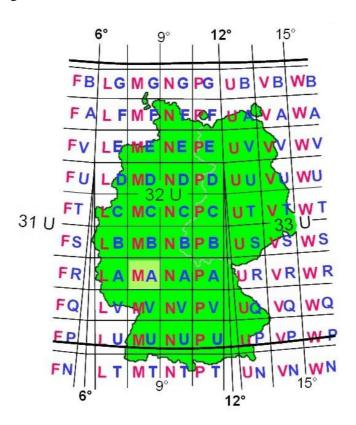
Die 100-km-Quadrate werden in östlicher und nördlicher Richtung mit Buchstaben bezeichnet. In einem Zonenfeld ist der erste Buchstabe bei allen in Nord-Süd-Richtung liegenden, der zweite Buchstabe bei allen in Ost-West-Richtung liegenden Quadraten gleich.
